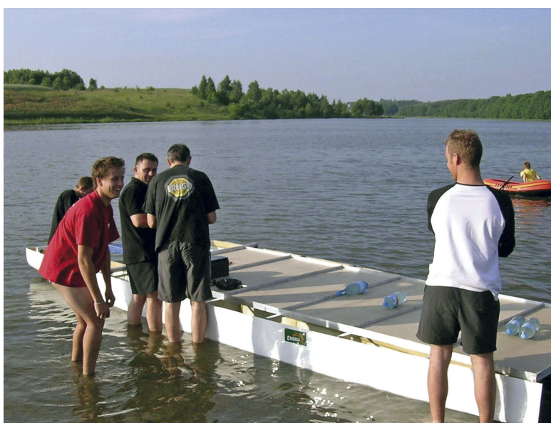
Fot. 4. Pierwsze próby zbudowanego przez studentów Koła Naukowego KORAB katamaranu solarnego ENERGA SOLAR, w maju 2006 roku na jeziorze Osowskim w Gdańsku; zamiast paneli fotowoltaicznych sklejką i balast – butelki z wodą Fot. Wojciech Litwin
