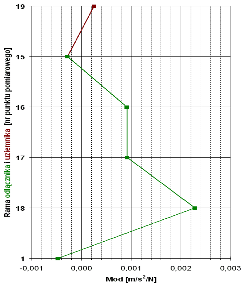
Rys. 3.38. Forma drgań ramy oraz uziemnika dla f_{R1} = 8,45 Hz.
