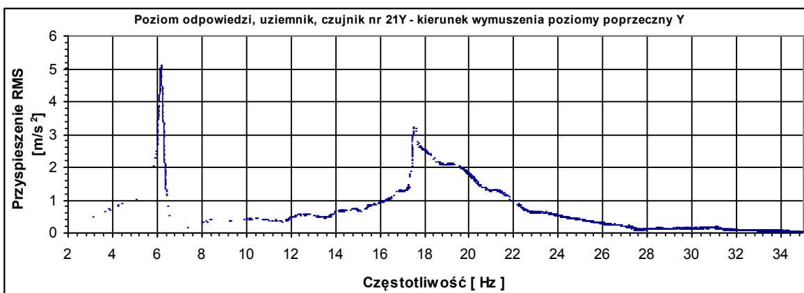
Rys. 3.78. Charakterystyki dynamiczne dla wymuszenia w kierunku Y dla odłącznika zamkniętego.
