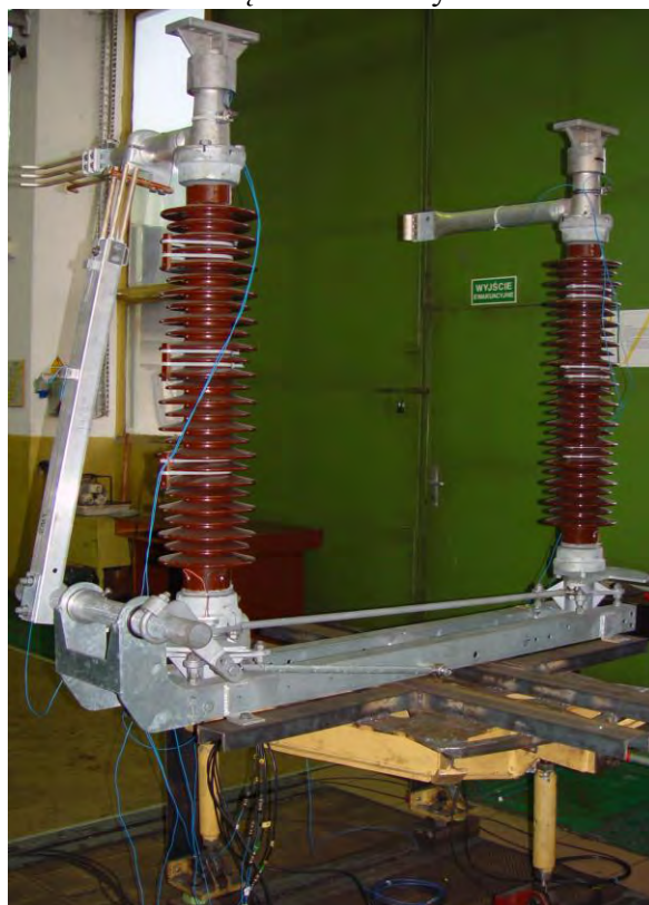
Fot. 3.3. Sposób zamocowania odłącznika na stole wstrząsowym w pozycji zamkniętej i otwartej (kierunek pobudzenia drgań poprzeczny, Y).
