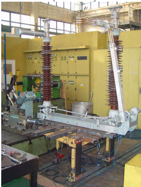
Fot. 3.4. Sposób zamocowania odłącznika na stole wstrząsowym w pozycji zamkniętej i otwartej (kierunek pobudzenia drgań wzdłużny, X).
