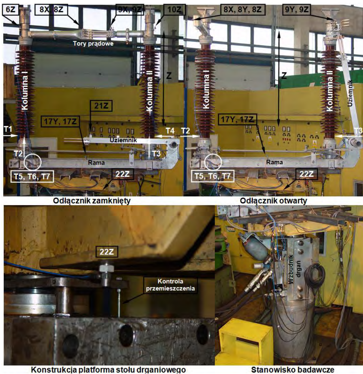
Fot. 3.11. Sposób zamocowania odłącznika i rozmieszczenie punktów pomiarowych dla kierunku wymuszenia drgań pionowego Z.
