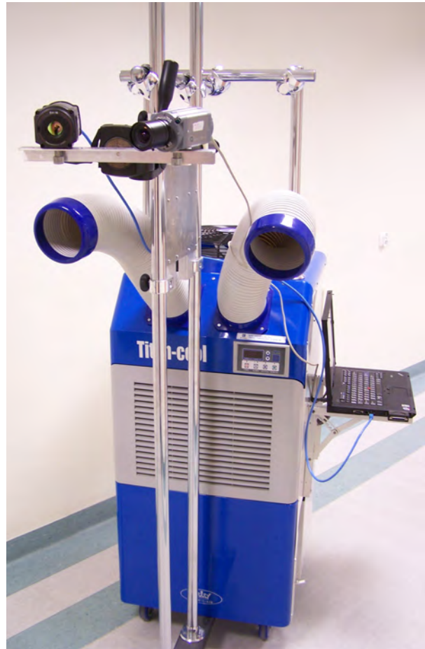
Rys. 10. Jednostka do wykonywania mammografii termicznej wykorzystująca strumień schłodzonego powietrza jako pobudzenie termiczne
