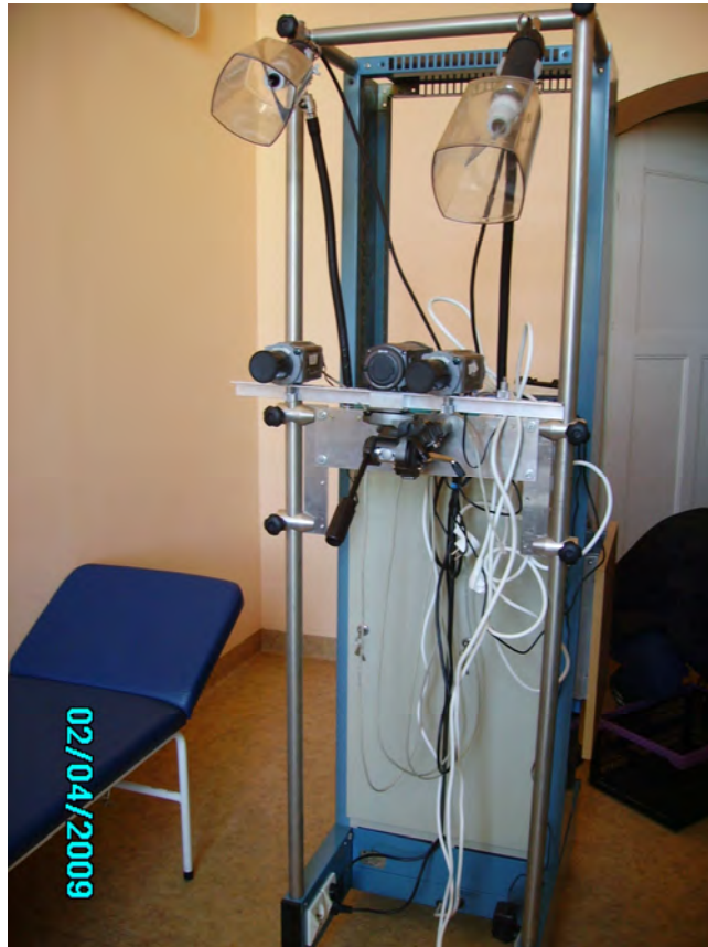
Rys. 9. Stanowisko do badań ADT z pobudzeniem termicznym przy pomocy rozprężającego się dwutlenku węgla [60]
