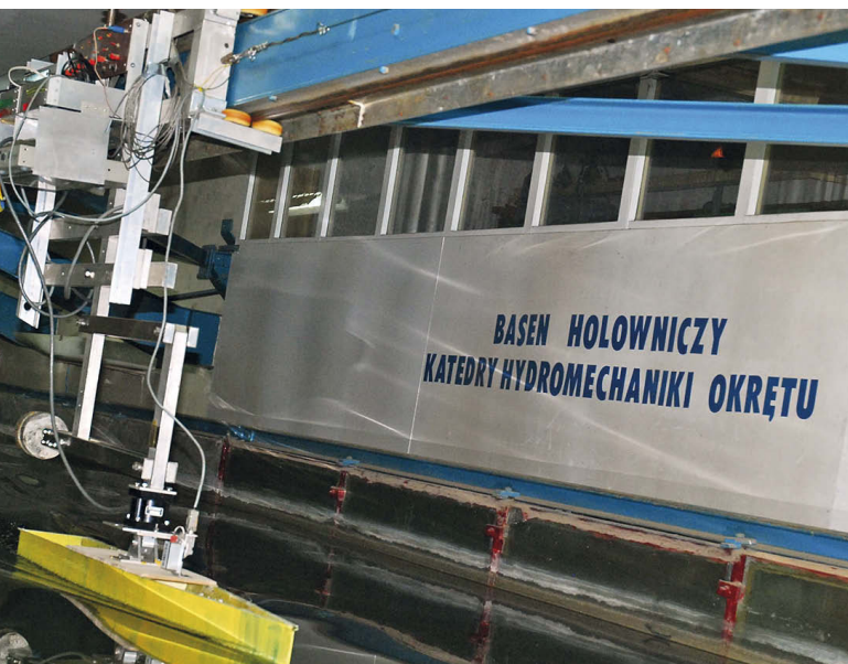
Fot. 10. Model regatowej łodzi ENERGA SOLAR w Laboratorium Hydromechaniki – Basenie Holowniczym na Wydziale Oceanotechniki i Okrętownictwa Fot. Wojciech Litwin
