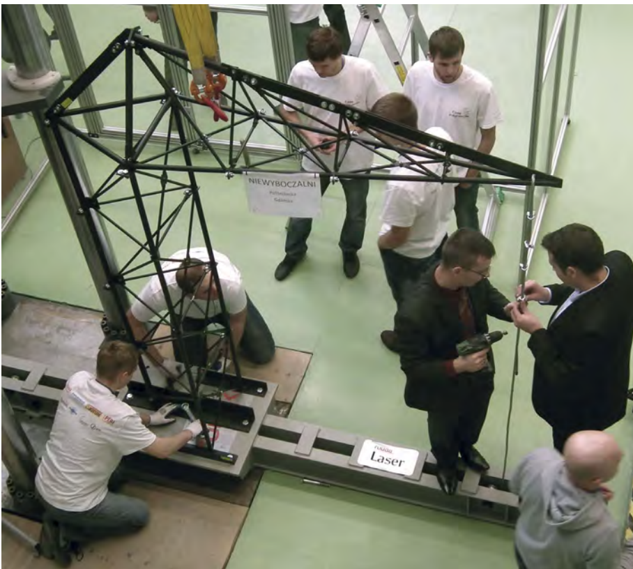
Fot. 2. Żuraw drużyny „Niewyboczalni” na stanowisku do obciążania
