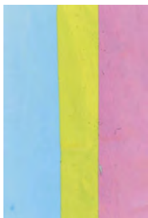
Fot. 6. Polaryzacja chromatyczna występująca w jednej, dwu i trzech warstwach taśmy klejącej nałożonych na siebie
