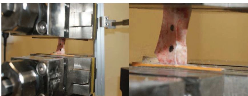
Ryc. 3.7. Próbka kości umieszczona w szczękach maszyny wytrzymałościowej z naniesionymi kropkami wyznaczającymi odcinek badany
