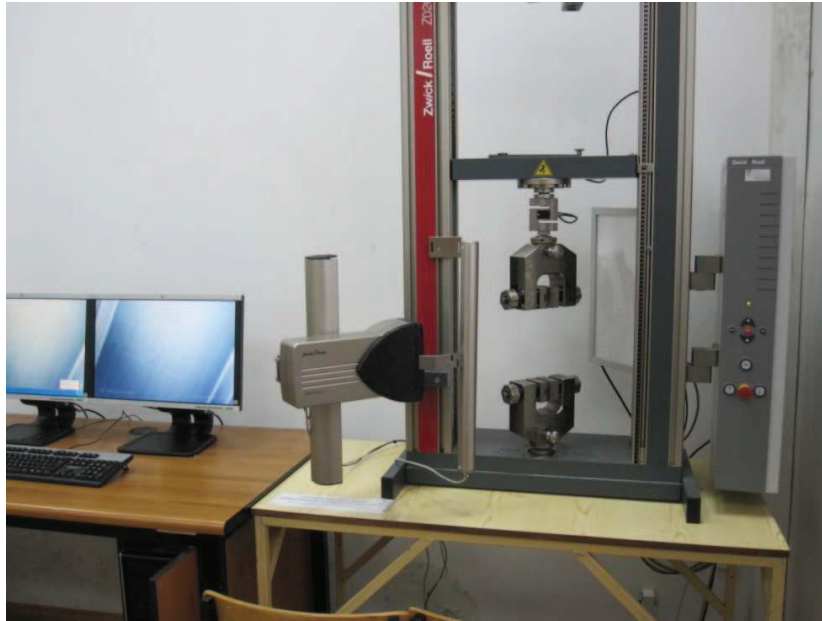
Ryc. 3.5. Pracownia Civitroniki Wydziału Inżynierii Lądowej i Środowiskowej. Maszyna wytrzymałościowa (Zwick Roell Z020) wraz z ekstensometrem Fig. 3.5. Civitronic Laboratory – Faculty of Civil and Environmental Engineering Gdansk University of Technology. The strength machine (Zwick Roell Z020) with extensometer
