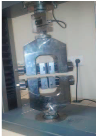
Ryc. 3.6. Szczęki maszyny wytrzymałościowej (Zwick Roell Z020) Fig. 3.6. Specimen holding jaws of the strength machine (Zwick Roell Z020)
