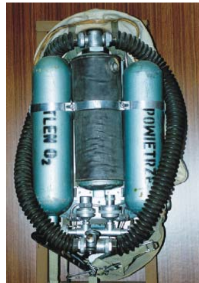
Photo 26. SC-automix-SCR APW-3 type
