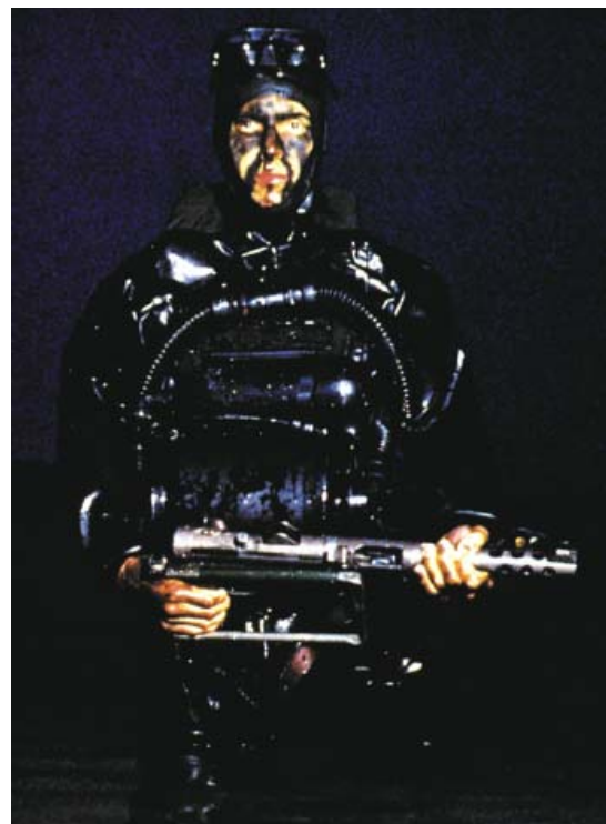
Photo 28. Oxy-CCR AGA-Oxydive type
