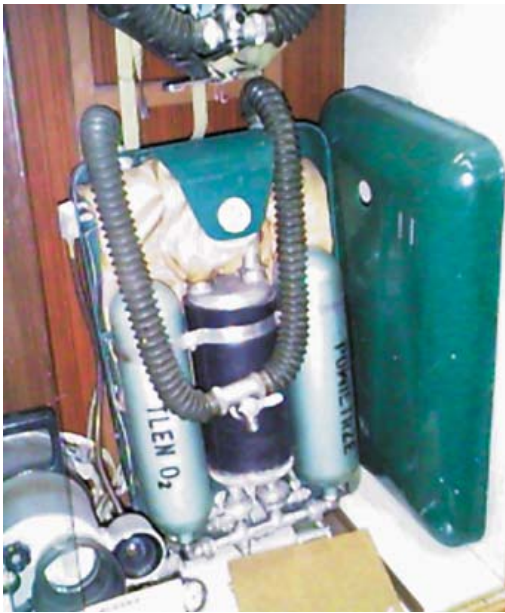
Photo 27. SC-automix-SCR APW-6 type
