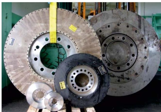
Fig. 10. Torsion dampers
