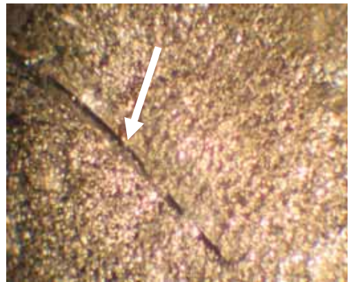
b) piston head – a crack fatigue
