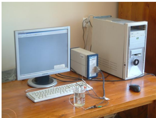
Rys. 4.5. Układ pomiarowy do badań impedancyjnych obejmujący potencjostat Gamry Instrument Potentiostat/Galvanostat/REF 600 , komputer oraz celkę pomiarową.
