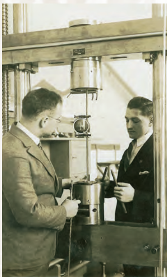
Fot. 9. Laboratorium wytrzymałościowe w Gródku – maszyna do zrywania Amslera Fot. ze zbiorów Archiwum Historycznego Elektroenergetyki Polskiej w Toruniu
