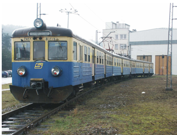
Rys. 2.5. Jednostka trakcyjna serii EN57 (lata produkcji 1962 – 1994)
