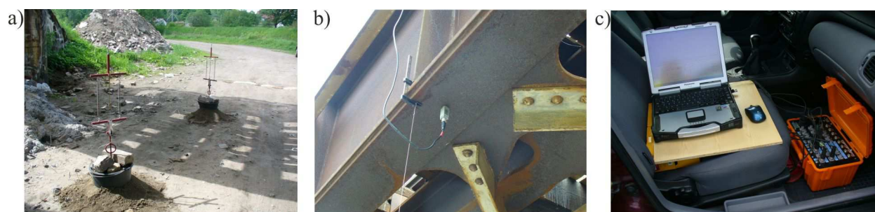
Rys. 5.47. Aparatura pomiarowa: a) przetworniki liniowego przemieszczenia NOVOTECHNIK serii T100, b) akcelerometr APEK MA-24.01, c) laptop i mostek pomiarowy APEK AV32AKProjek
