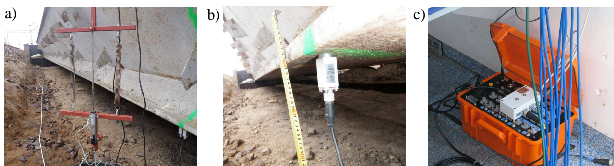
Rys. 5.24. Aparatura pomiarowa wykorzystana podczas badań przęsł KO30: a) przetwornik liniowego przemieszczenia NOVOTECHNIK serii T100, b) akcelerometr APEK MA-24.01, c) 16-to kanałowy mostek pomiarowy APEK AV32AKProjek
