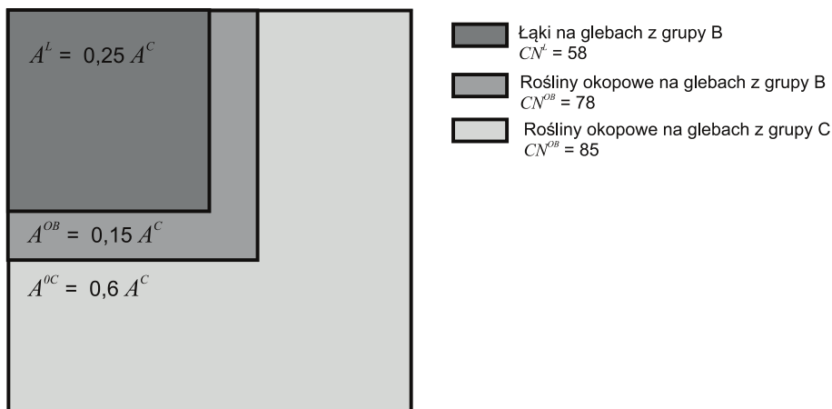
Rys. 1.14. Schemat użytkowania zlewni przedstawionej w przykładzie; A^c oznacza całkowitą powierzchnię zlewni
