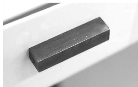
Rys. 8.35. Dodatkowy element usztywniający na powierzchni łopaty symulujący uszkodzenie poszycia. Źródło: opracowanie własne
