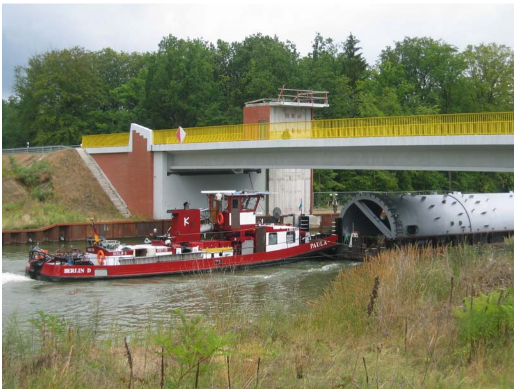
fot. 5.1. Transport elementów wielkogabarytowych drogami wodnymi na kanale żegludowym Odra-Havela.
