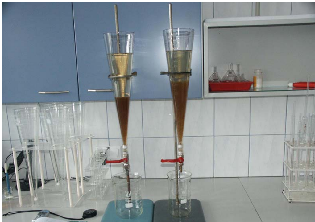
Fot. 7.3. Przykładowe wyniki zagęszczania osadu (różnica w czasie zagęszczania - 10 minut)
