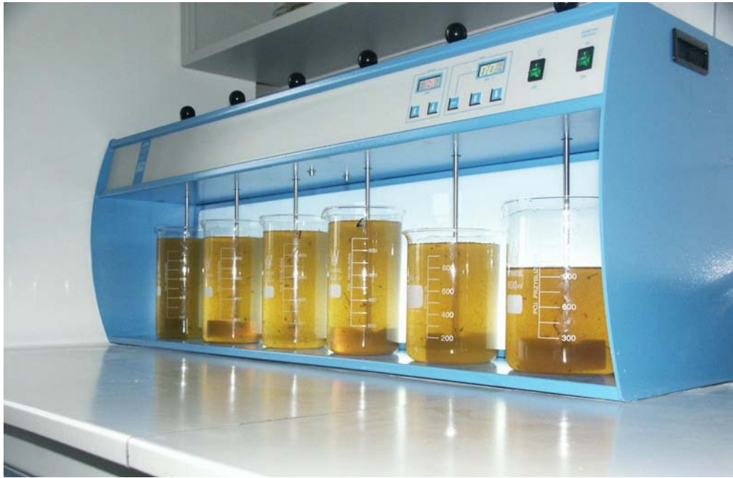
Fot. 7.1. Przygotowanie osadu do badań (koagulacja)
