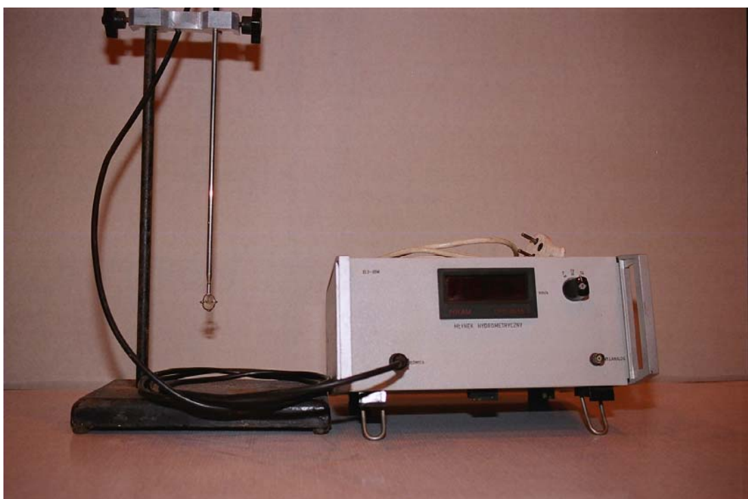
Fot. 6.12. Mikromłynek hydrometryczny (sonda wraz z rejestratorem)
