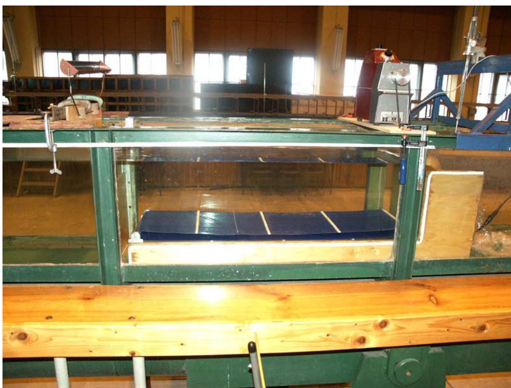
Fot. 6.16. Widok ogólny stanowiska pomiarowego w wersji ze „zgarzniaczem osadu”
