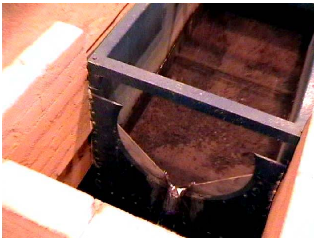
Fot. 6.6. Przelew Thomsona u wylotu kanału laboratoryjnego
