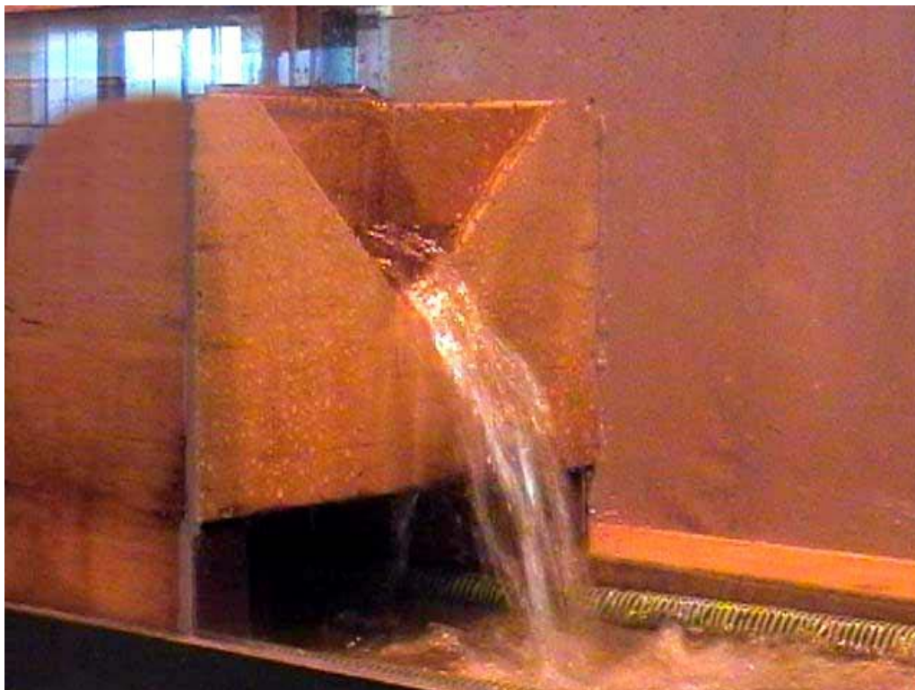
Fot. 6.3. Przelew odpływowy u wylotu ze stanowiska pomiarowego
