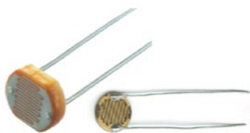
Rys. 49. Budowa typowych fotorezystorów z CdS.
