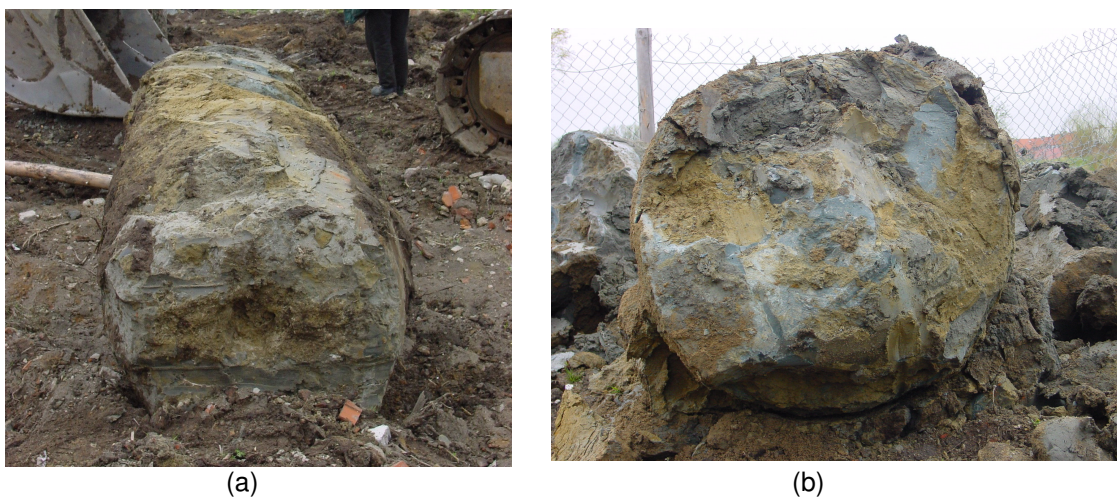
Rys.5.9 Wykopane odcinki kolumn badawczych: (a) kolumna D1, (b) kolumna D2.
