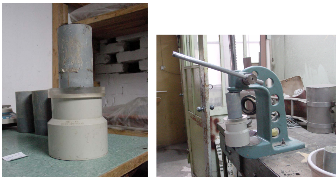
Rys. 4.3 Wyposażenie stanowiska: podstawa i urządzenie do wyciskania próbek cementogruntu.
