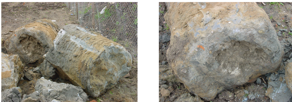
Rys. 5.11 Wydobyte fragmenty kolumny badawczej D4.
