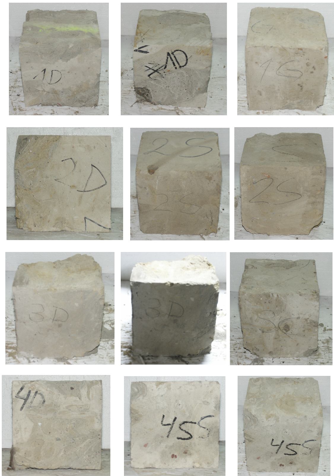
Rys. 5.19 Przykładowe próbki sześciennie 20x20x20 cm, wycięte z wydobytych odcinków kolumn badawczych D1 do D4.
