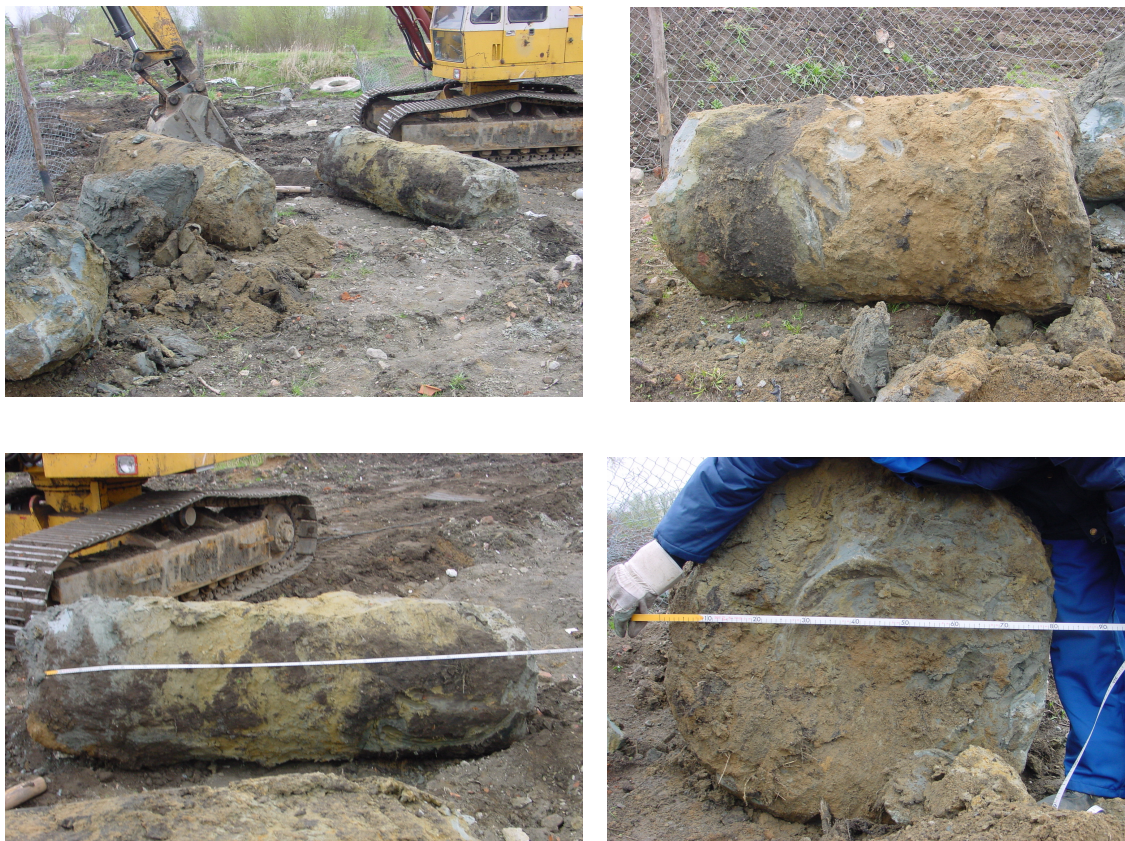
Rys. 5.8 Odkopane i wyciągnięte na powierzchnię kolumny badawcze. Pomiar średnicy i długości wydobytych odcinków kolumn.
