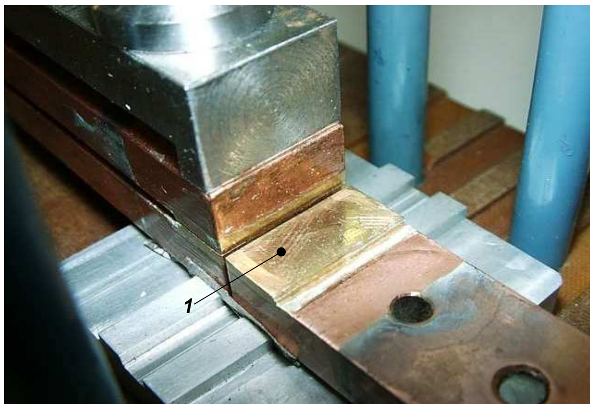
Rys. 4.5. Powiększenie zacisków i szczeliny o długości 1 mm, 1- złożone powierzchnie
