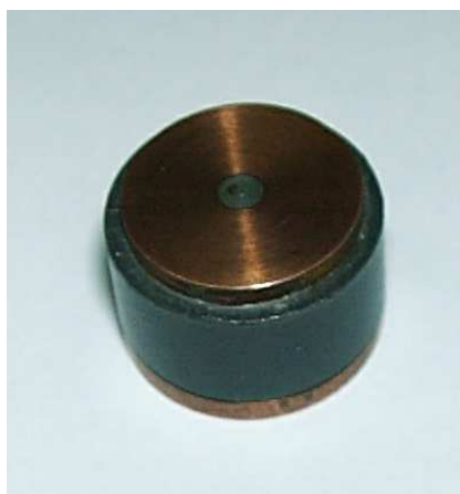
Rys. 4.17. Fotografia wkładki krótkotopikowej wykonanej w Katedrze Wysokich Napięć i Aparatów Elektrycznych PG
