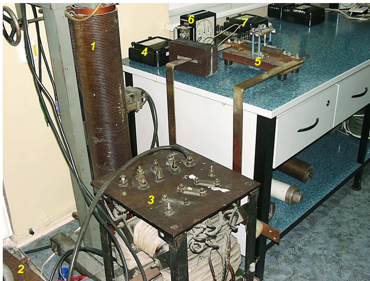
Rys. 4.13. Układ probierczy do badania obciążalności długotrwałej o maksymalnej wydajności prądowej 1600 A: oznaczenia części układu są zgodne z rys. 4.12.
