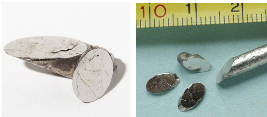
Fot. 3. Kryształ pierwszego trójwymiarowego topologicznego izolatora \text{Bi}_2\text{Se}_3 . Błyszczące powierzchnie są miejscem egzotycznych elektronicznych stanów powierzchniowych
