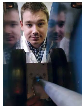
Doktorant Katedry Fizyki Zjawisk Elektronowych mgr inż. Maciej Klein przy stanowisku pomiarowym do badania wpływu zewnętrznego pola magnetycznego na wydajność organicznych diod elektroluminescencyjnych i ogniw fotowoltaicznych
