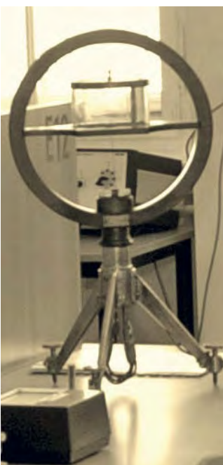
Fot. 2. Busola stycznych – przyrząd do wyznaczenia składowej poziomej natężenia pola magnetycznego Ziemi
