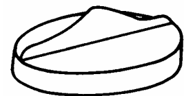
Rys. 4.6. Próbka po spęczeniu z wypływką
