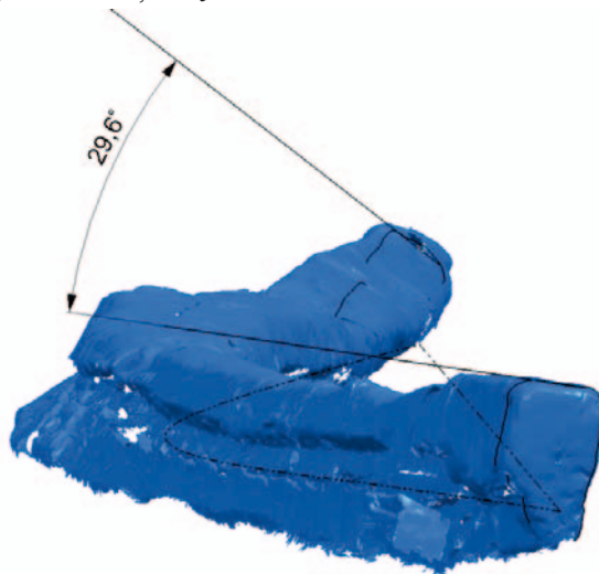
Il. 28. Pomiary skrócenia stępki wraku W-5
