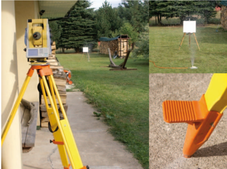
II. 32. Stanowisko do skanowania płyt wzorcowych
