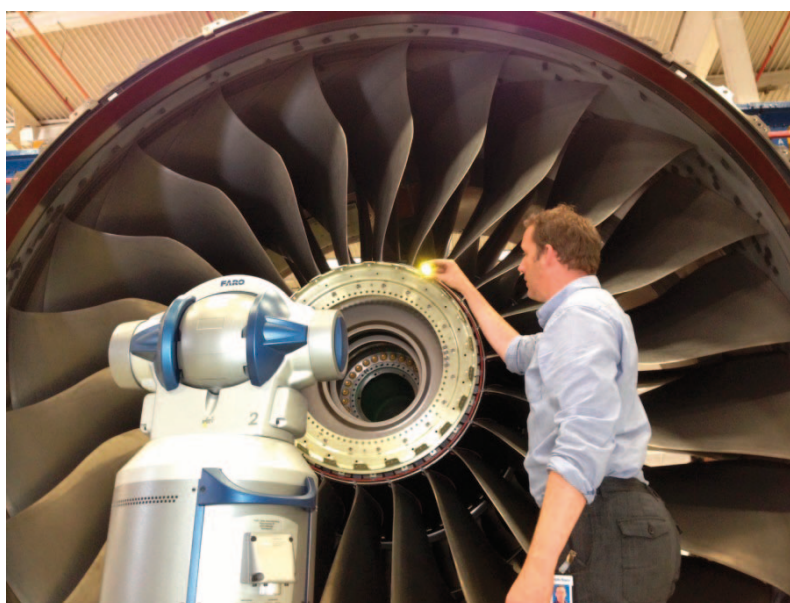
Il. 4. Idea skanowania za pomocą trackera [25]
