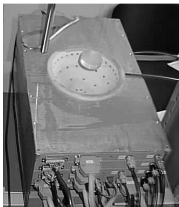
Rys. 5.23. Widok głowicy pomiarowej. Ciemniejsze kropki ułożone w czterech rzędach to elektrody zespolone składające się z elektrody aplikacyjnej (prądowej) w postaci pierścienia i pomiarowej w postaci centralnego krążka
