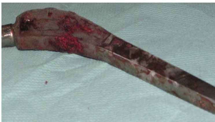
Rys. 5.3. Zmiany korozyjne na powierzchni materiału [14]
