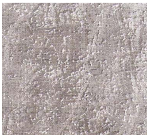
Rys. 6.14. Struktura dendrytyczna stopu Co-Cr-Mo, zgląd wzdłużny, pow. 50× (mikroskop skaningowy) [3]
