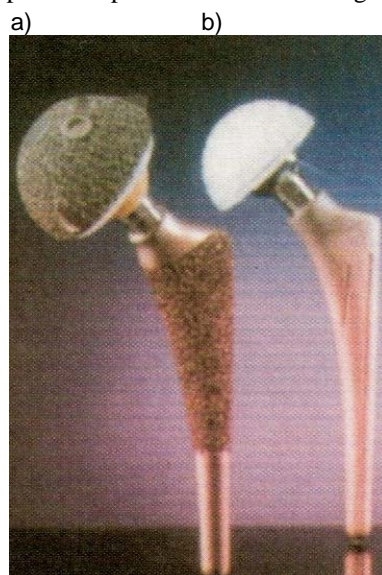
Rys. 6.6. Całkowite endoprotezy stawu biodrowego, model ESKA: a) bezcementowa z ziarnistą powłoką w strefie podkrętarzowej trzpienia i panewki zakładanej na docisk, b) cementowa z panewką pośrednią polietylenową [9]
