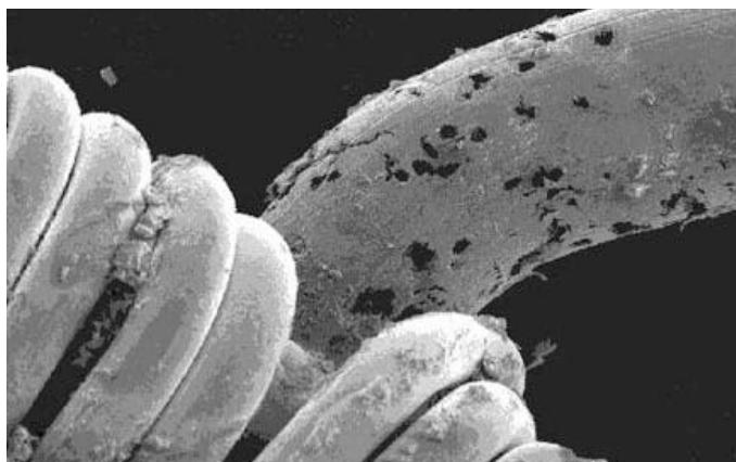
Rys. 4.6. Pitting na powierzchni wykonanej za stopu NITINOL (powiększenie \times 200 ) [21]
