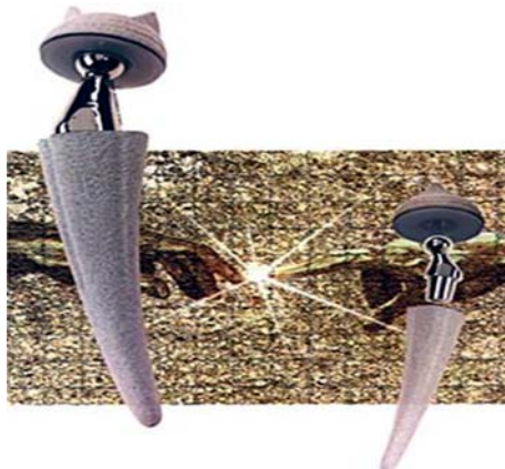
Rys. 4.4. Endoprotezy stawu biodrowego: a) trzon – Ti-6Al-4V, podwójna powłoka natryskiwana plazmowo (hydroksyapatyt); główka – ceramika; b) trzon – stal austenityczna; główka – stal austenityczna lub ceramika ZrO 2 ; zamocowanie – cement; c) trzon – stop tytanu z powłoką hydroksyapatytową; główka – stal austenityczna lub ceramika [9]
