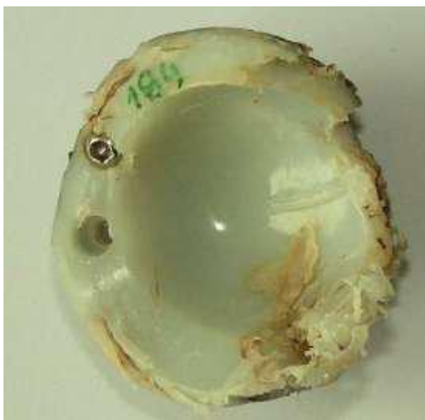
Rys. 4.9. Zużycie panewki stawu biodrowego [25]
