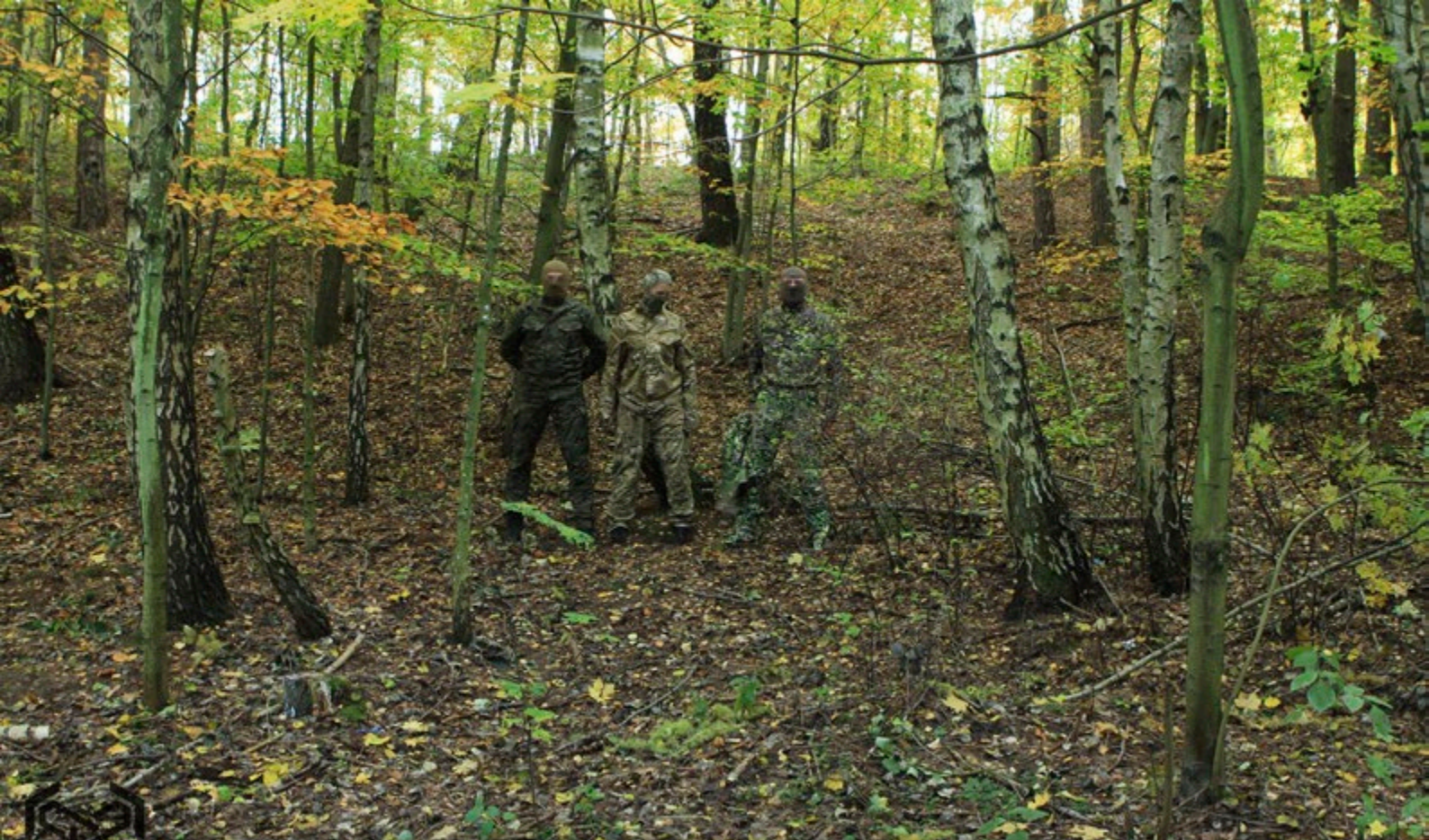
Testy porównawcze w terenie: WZ.93 PANTERA, MULTICAM, MAPA A i B - dystans 20 m.
