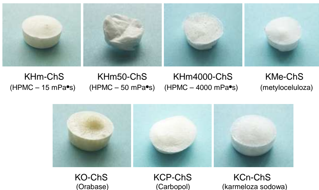
Ryc. 29. Wygląd krążków liofilizowanych zawierających ChS (substancję).
