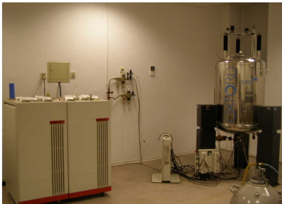
Rycina 9. Spektrometr NMR firmy Varian, typ: Unity 500 plus w pracowni Rezonansu Magnetycznego PG
