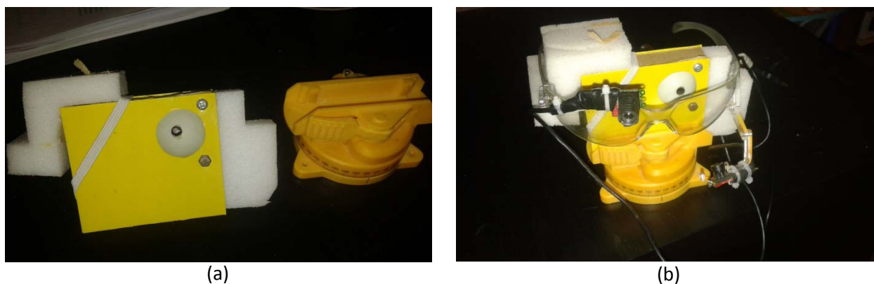
Rys. DC. 3. Model oka a) rozłożony na części, b) złożony w konfiguracji do testów dokładności interfejsu eTrack
