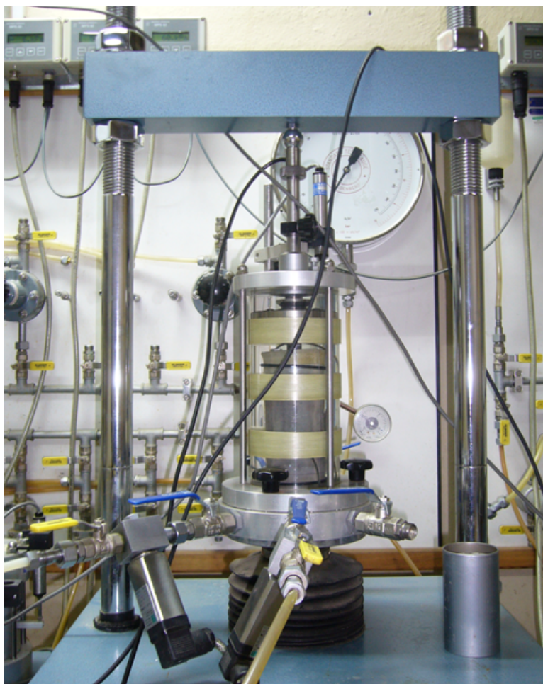
Rysunek 7.2: Zamontowana próbka typu NNS przed przeprowadzeniem badań ścinania w aparacie trójosiowego ściskania.
