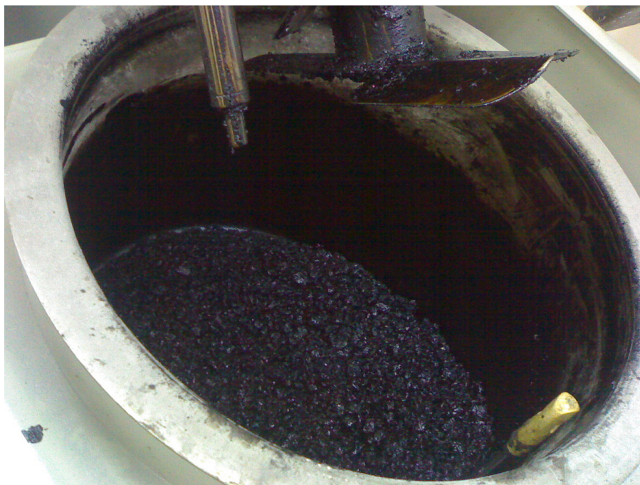
Fot. 4.7. Widok wnętrza mieszarki wykorzystywanej do produkcji mieszanek w warunkach laboratoryjnych. U góry zdjęcia widoczny jest czujnik temperatury oraz wał mieszadła z łopatkami
