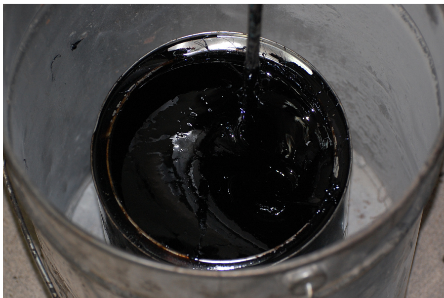
Fot. 4.5. Mieszanie asfaltu z dodatkiem WMA przy szybkich obrotach mieszadła
