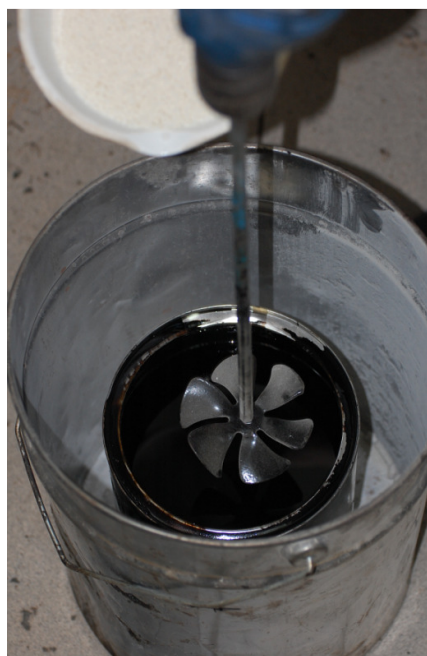
Fot. 4.2. Mieszadło łopatkowe zamocowane w uchwycie wiertarki przeznaczone do modyfikacji dużych ilości asfaltu
