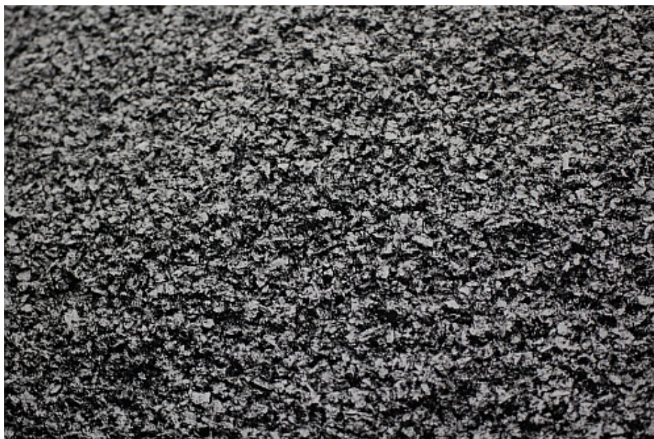
Fot. 6.1. Widok mieszanki SMA wyprodukowanej ze środkiem Ceca Base RT po załadunku do skrzyni samochodu ciężarowego
