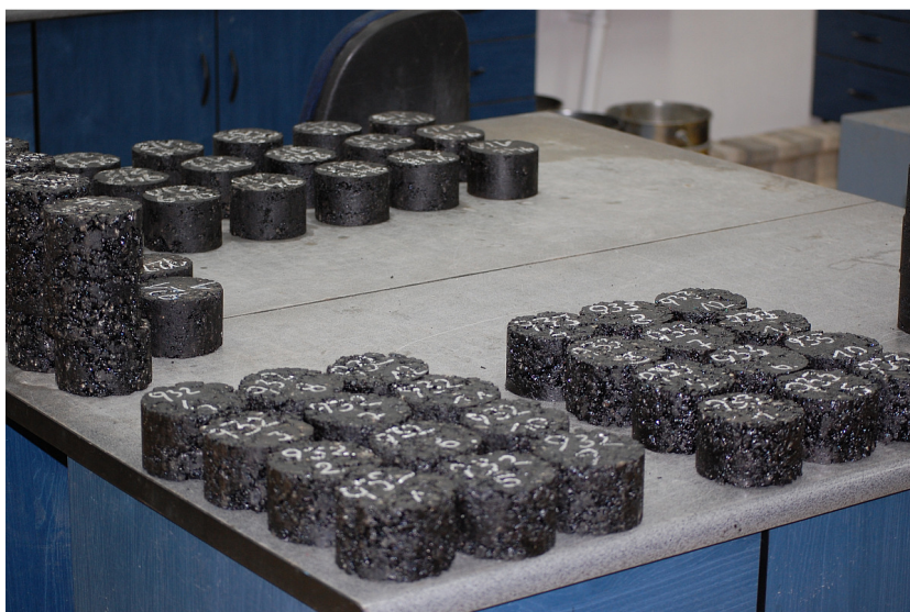
Fot. 4.8. Próbki walcowe wykorzystywane w badaniach stabilności, odporności na działanie wody i mrozu oraz starzenia
