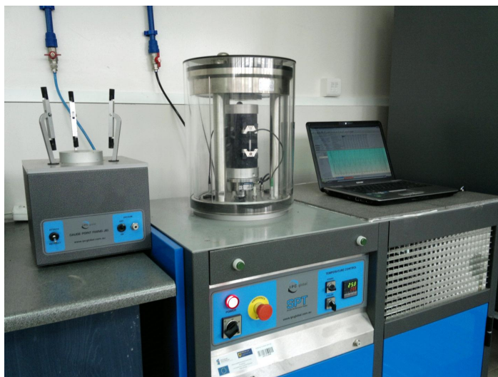
Fot. 7.1. Widok ogólny urządzenia AMPT/SPT. W centrum widoczna komora z próbką
