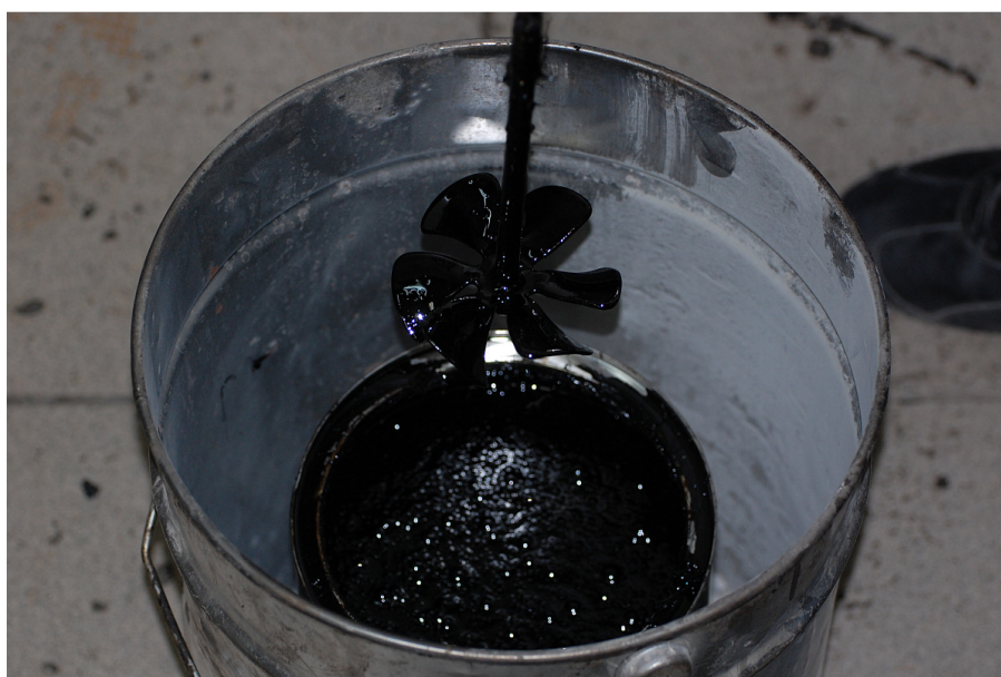
Fot. 4.6. Asfalt z dodatkiem WMA po zakończeniu mieszania
