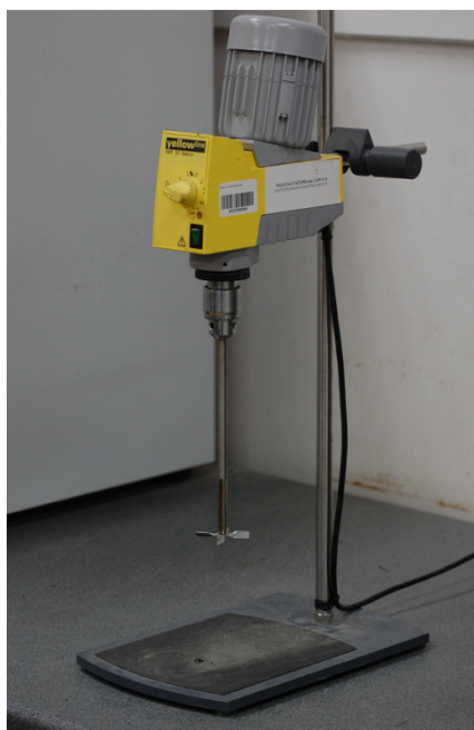
Fot. 4.1. Mieszadło laboratoryjne stosowane do modyfikacji dodatkami WMA niewielkich ilości asfaltu
