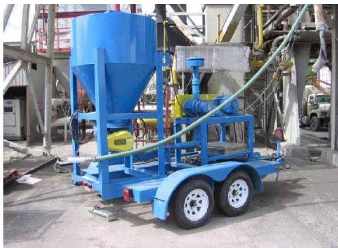
Fot. 2.15. Przewoźny silos zeolitu współpracujący z otaczarnią o działaniu ciągłym [35]
