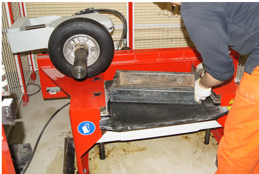
Fot. 6.6. Przygotowywanie formy 500 x 180 x 50 mm w zagęszczarce PC-BBAC
