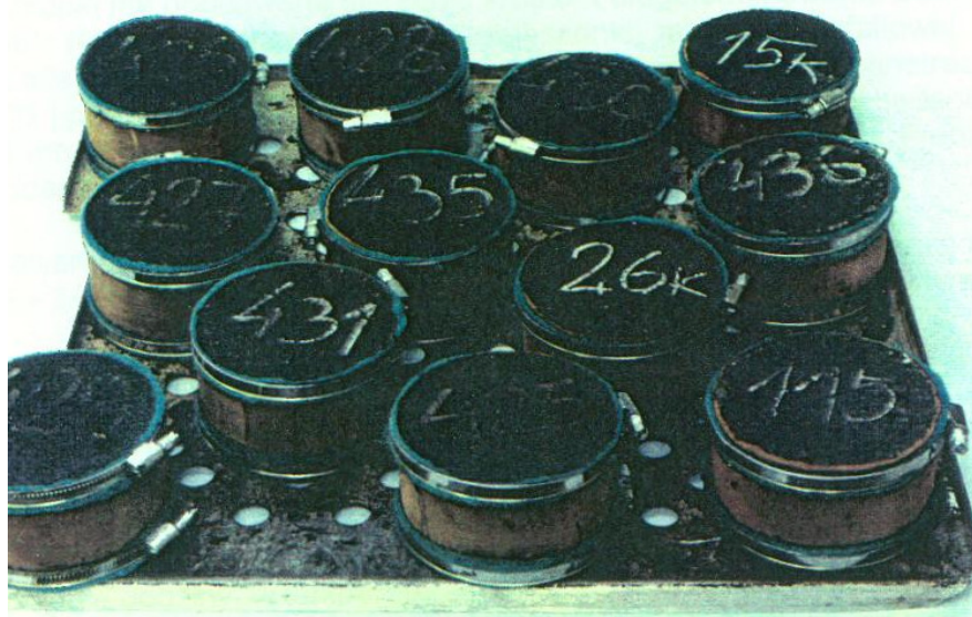
Fot. 4.14. Widok próbek walcowych w osłonkach z siatki miedzianej przygotowanych do starzenia długoterminowego
