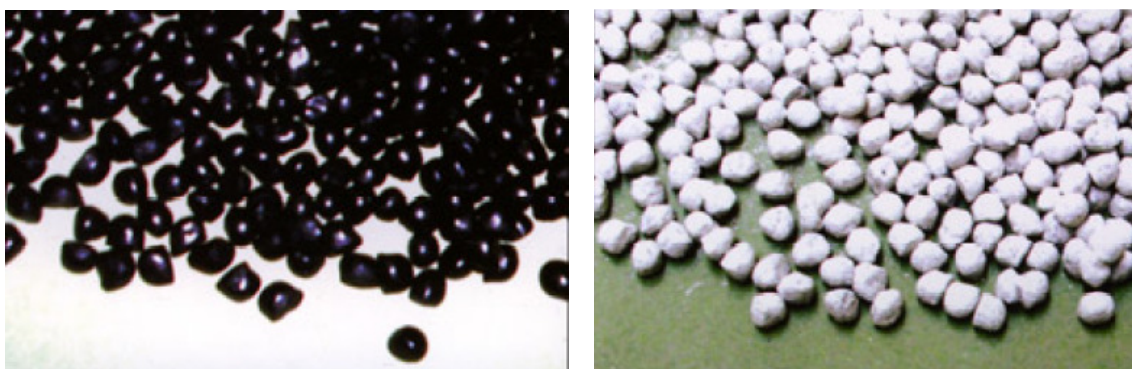
Fot. 2.9. Dodatek TLA-X Warm Mix w wersji powleczonej i niepowleczonej asfaltem [72]
