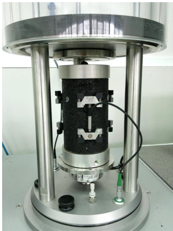
Fot. 7.2. Próbką walcową średnicy 100 mm i wysokości 150 mm umieszczona w uchwytach aparatu AMPT/SPT. Widoczne są czujniki LVDT rejestrujące skrócenie próbki w momencie obciążenia
