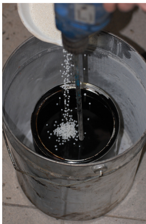
Rys. 4.4. Dozowanie dodatku WMA do asfaltu przy jednoczesnej pracy mieszadła na wolnych obrotach
