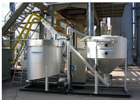
Fot. 2.3. Dozator przeznaczony do współpracy z wytwornią o działaniu cyklicznym. Widoczne dwa zbiorniki – jeden do przechowania granulek, drugi do ich podgrzewania [77]
