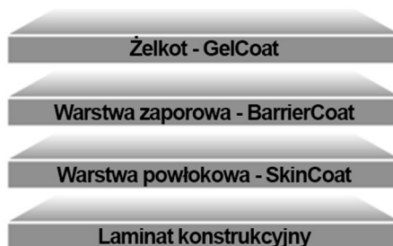
Rys. 4. Schemat budowy złożonego systemu laminatu ścianki kadłuba jachtu
