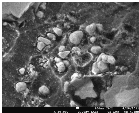
Rys. 60. Nanocząstki widoczne są jako sieć drobnutkich cząstek w ciemnej osnowie (żywicy) na ciemnym tle żelkotu 10%N „materiały 1”
