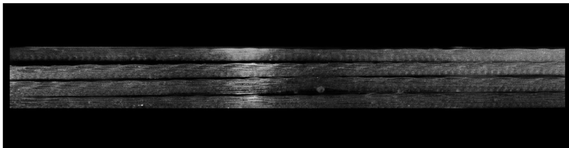
Rys. 102. Zdjęcie makroskopowe przekroju w miejscu udaru dla próbek 0%, 3%, 5% i 10% nanocząstek w osnowie
