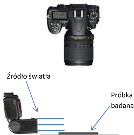
Rys. 34. Schemat ideowy systemu rejestracji pęcherzyków na powierzchni laminatu.
