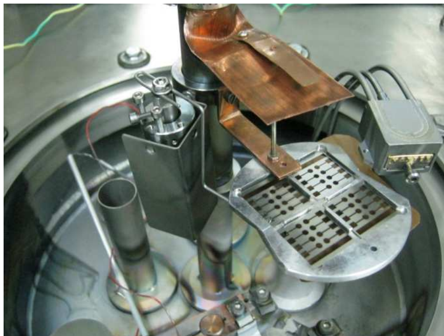
Rys. 13. Komora ewaporacyjna napyłarki próżniowej z widoczną maską selektywną do osadzania katody z fazy gazowej na podkładach z ITO.
