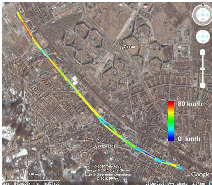
Rys. 7.11. Mapa warunków eksploatacji dla fragmentu głównej arterii komunikacyjnej Trójmiasta – średnia prędkość jazdy \bar{V} , godz. 12 00 – 15 00
