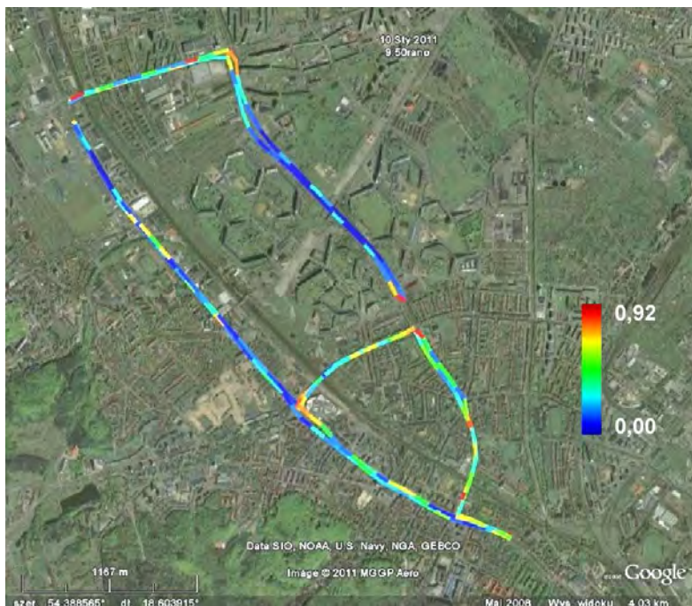
Rys. 7.4. Mapa warunków eksploatacji – udział czasu pracy silnika na biegu jałowym w stosunku do całkowitego czasu jazdy t_b/t_c
