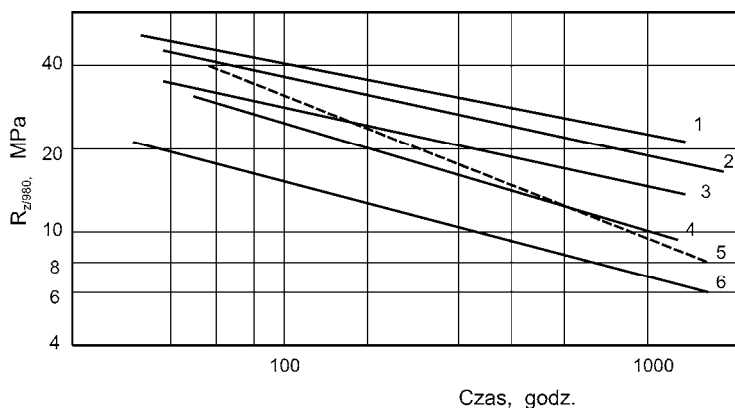
Rys. 10. Wytrzymałość na pełzanie R_{Z/980} staliw żarowytrzymałych [32]: 1 – staliwo 20Cr25Ni 0,40% C, 2 – staliwo 25Cr20Ni 0,40% C, 3 – staliwo 25Cr20Ni 0,35% C, 4 – staliwo 25Cr12Ni 0,40% C, 5 – staliwo 15Cr35Ni 0,40% C, 6 – staliwo 25Cr12Ni 0,10% C
