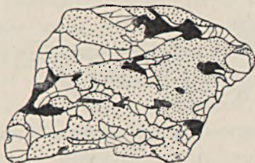
Starkt deformerad granit af perthit-kvartstypen från Varberg. Beteckningarna de samma som i fig. 2. \frac{3}{4} af den nat. storleken. Under deformationen har i denna bergart fältspaten blifvit fullständigt granulerad.
