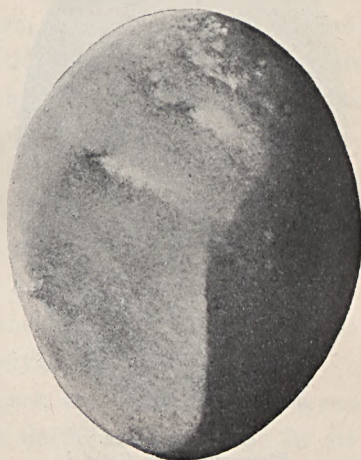
Samma sten som fig. 7. Omkring nat. storlek. Efter nära 2 timmars sandpåblåstring. Vigt. 133.00 g.
