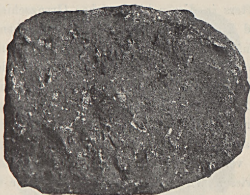
Fig. 15. Apatit-Magnetiterz mit Eisenglanzkrystallen. Skärningen. \frac{1}{2} .
