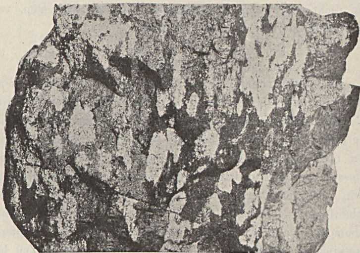
Fig. 17. Apatiterz aus der N. Hammargrube. Hell = Apatit; hellgrau = Magnetit; dunkel = Pyroxen und andere Silikate. 2 / s .
