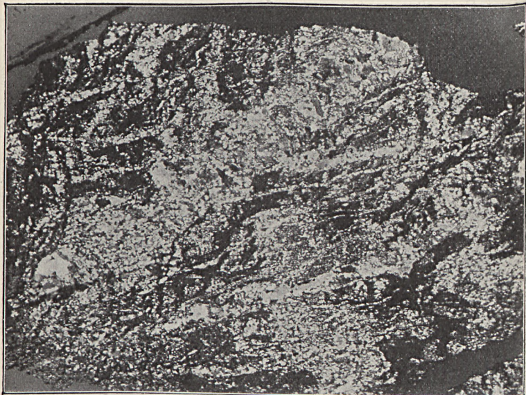
Fig. 13. Kataklastisches Gestein, aus einem älteren Schiefer durch Quetschung und Faltung entstanden. Läktatjälkko. Vergr. 8 \times . Nic. gekr.
