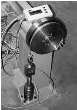
Rys. 4.16. Ideowy schemat urządzenia służącego do wymuszania momentu skręcającego
