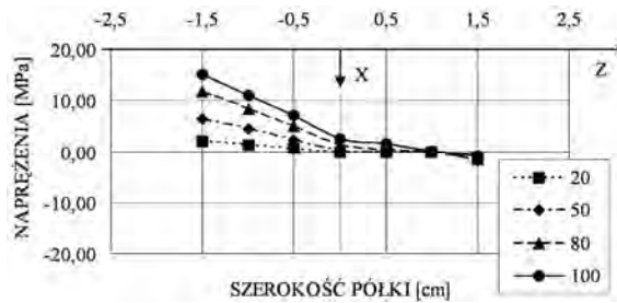
Rys. 4.28. Rozkład naprężeń normalnych w półce dolnej w przekroju 2 od obciążenia momentami skręcającymi 20, 50, 80, 100 [Nm]
