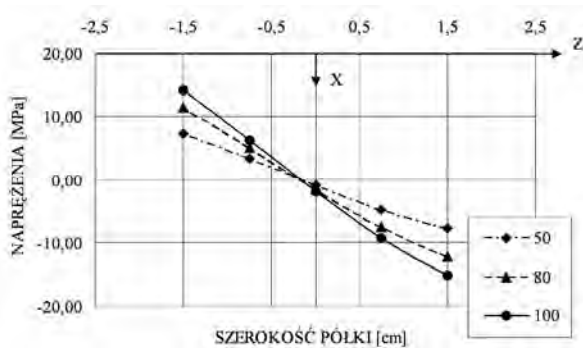
Rys. 4.63. Rozkład naprężeń normalnych w półce górnej w przekroju 4 od obciążenia momentami skręcającymi 50, 80, 100 [Nm]
