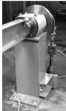
Rys. 4.16. Ideowy schemat urządzenia służącego do wymuszania momentu skręcającego
