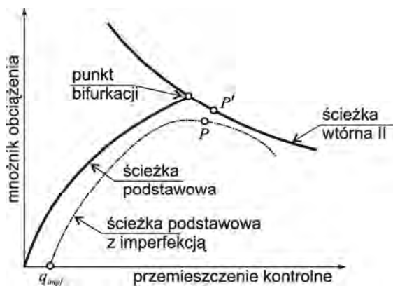
Rys. C.1. Śledzenie ścieżki deformacji metodą zaburzeń
