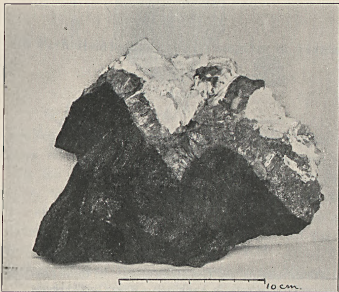
Fig. 2. Quarz-Prehnitgang mit Sahlband aus Prehnit (grau), amphibolitischen Nebengestein (schwarz) und Gangmitte aus Quarz (hell).
