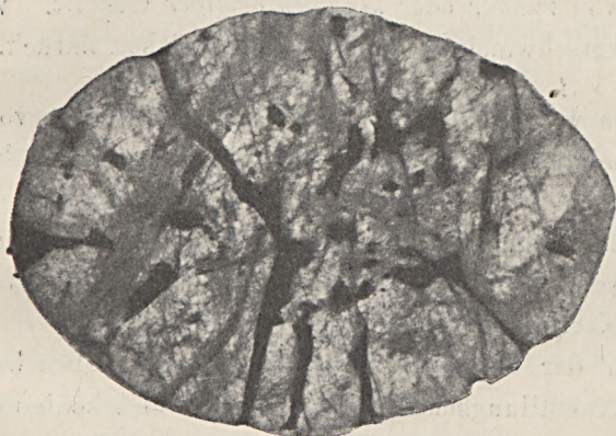
Fig. 5. Mikrophotographie einer dicken Platte aus Porphyrquarz von Hammarudda auf Island in durchfallendem Lichte. Man sieht die bedeutenden Mengen von fremder Substanz (rotem Feldspat), die diese Quarze enthalten. Sie haben die Gestalt von 1) gangähnlichen oder 2) schlauchartigen Bildungen, und offenbar kommen auch 3) wahre Einschlüsse z. T. von sehr winzigen Dimensionen vor. Vergrößerung ungefähr 10 ×.
