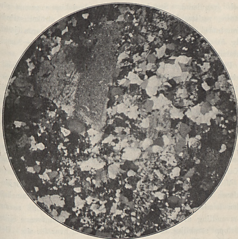
Fig. 5. Struktur hos gneisgranit från trakten öster om Halfvarsbening. Först. 16 ggr. Nic. +. En plagioklastafa med delvis idiomorf begränsning framträder i en söndermald kvarts-mikrolinmassa.
