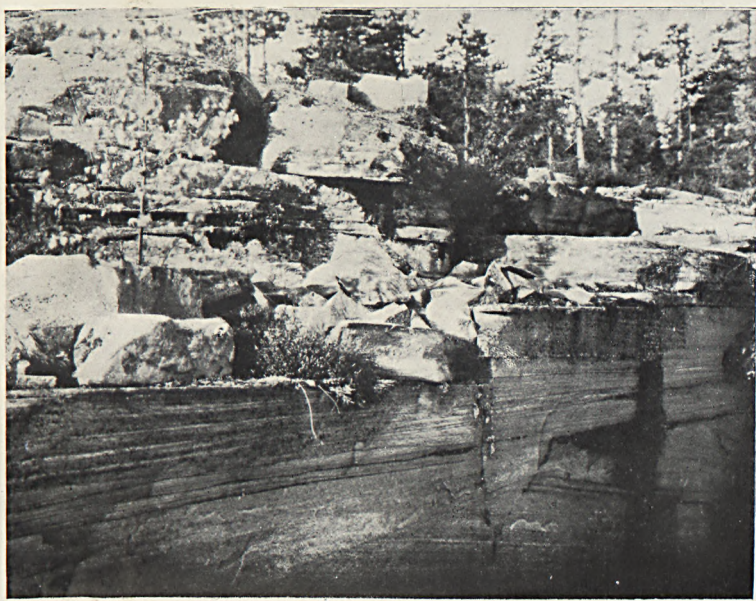
Fig. 1. V ägg i sandstensbrotten vid M ängsbodarna Älvdalen, visande bankning och diagonalsiktning. Väderstreck SE—NW. Förf. foto 22/9 1917.
