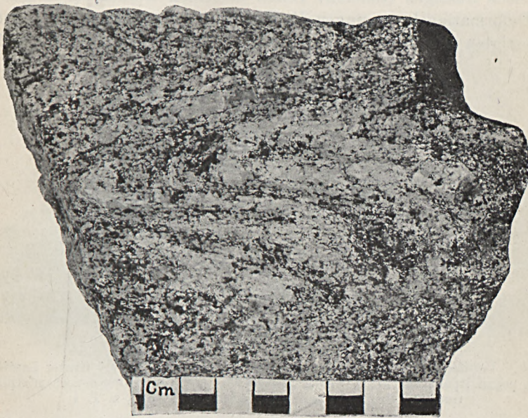
Fig. 8. Venitgneis aus Wärmland, Westschweden. Geschieferter und kleingefalteter Gneisgranit mit beginnender Aderbildung durch Umformung der älteren Struktur Typus 1.
