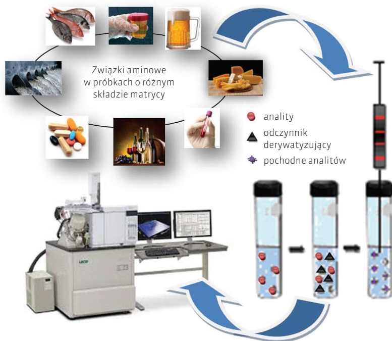
Proces derywatywacji jako jeden z etapów przygotowania próbek do analizy
