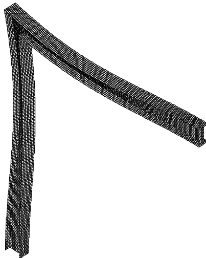
Rys. 2.44. Druga postać drgań własnych, n_2 = 32,88 Hz
