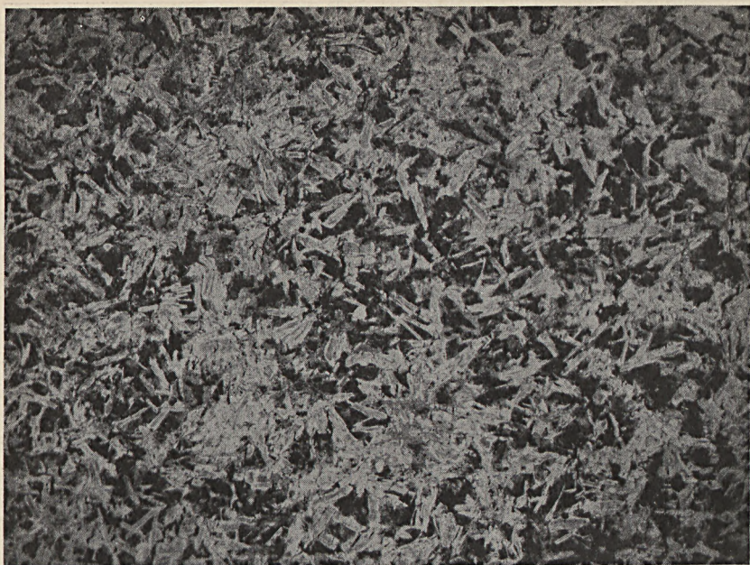
Fig. 6. Gångdiabas från Säbytorp, St. Kils socken. Mikrofoto, vanligt ljus, \times 7 .
