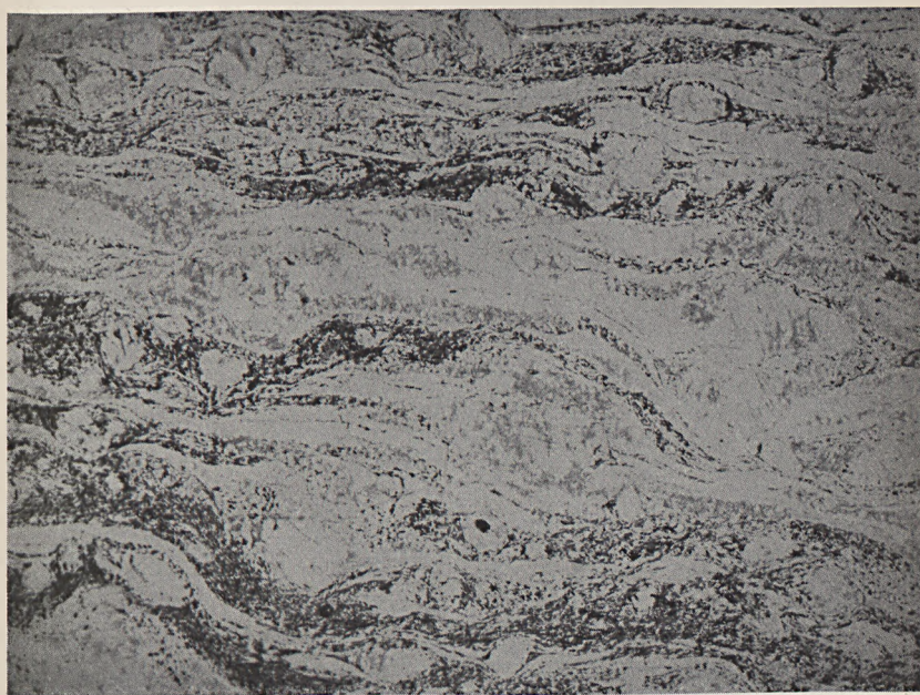
Fig. 5. Granitmylonitgnejs från Kammersrudshöjden, St. Kils socken. Mikrofoto, vanligt ljus, \times 5 .
