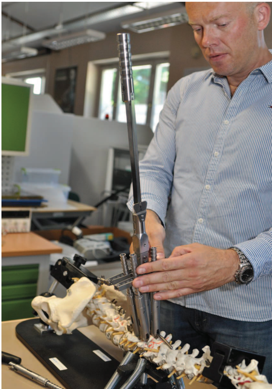
Ryc. 60. Prototyp derotatora Pankowskiego. Testy i kalibracja. Zielona Góra 2015 Fig. 60. Prototype of the Pankowski spinal derotator. Testing and calibration. Zielona Góra 2015
