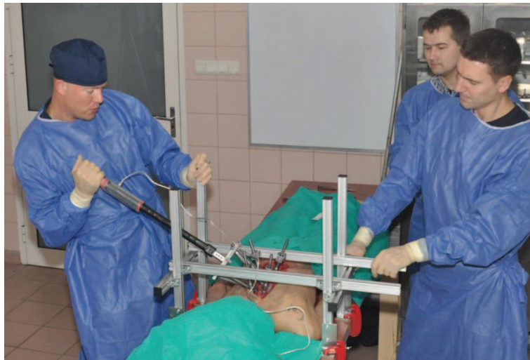
Ryc. 32. Kompletnie stanowisko badawcze w trakcie realizacji doświadczenia – symulowana derotacja
